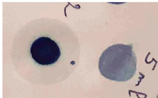
On obtient le type de buvard de la photo ci-dessus. Sur le zoom de droite on aperçoit l'auréole à gauche (dernière mesure) mais pas à droite (première mesure).
